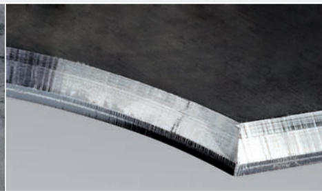
Fase / bevel (4 mm x 45° / c = 5,7 mm)
