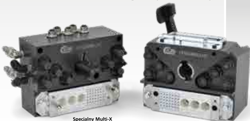
Specjalny Multi-X Multi-X ze złączami instalacji chłodniczej, pneumatycznej i elektrycznej do zastosowań w hartowaniu w procesie tłoczenia i spawaniu.
