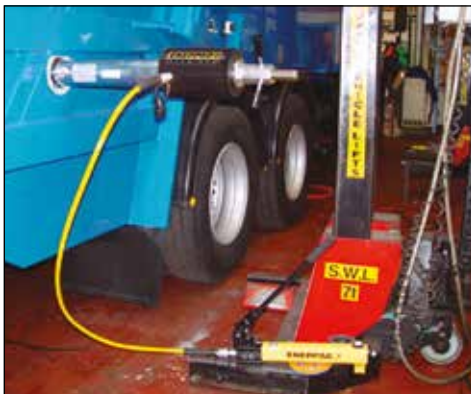
◀ Urządzenie RACH-306, napędzane pompą ręczną P-392, służy do wyciągania skorodowanych czopów karoseryjnych z ześlomowanych samochodów.
