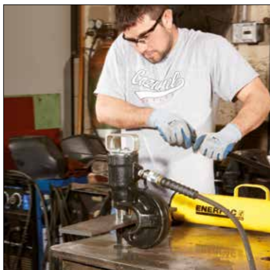
◀ STP-35H lekki przebijak hydrauliczny – znacznie szybsze od wiercenia.
