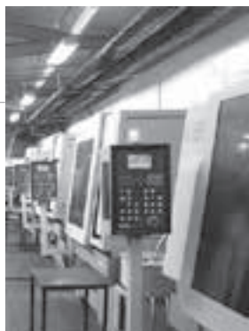
Lata 90-te, 2000-ne_Proces ostrzenia pił z węglnikami spiekanymi na zautomatyzowanych ostrzarkach
