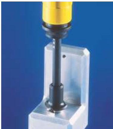
POGŁĘBIACZ GT Teleskopowy pogłębiacz stożkowy do pogłębiania i fazowania otworów. Przydatny do głębiej położonych otworów. GT-COUNTERSINK EL1300GT
