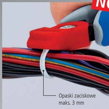
Usuń główkę opaski zaciskowej za pomocą szczypiec tnących bocznych dla elektroników...
