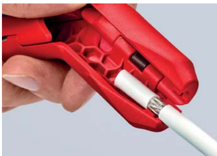
Usuwanie izolacji z kabli koncentrycznych
