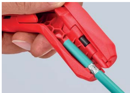
Usuwanie izolacji z przewodu teleinformatycznego
