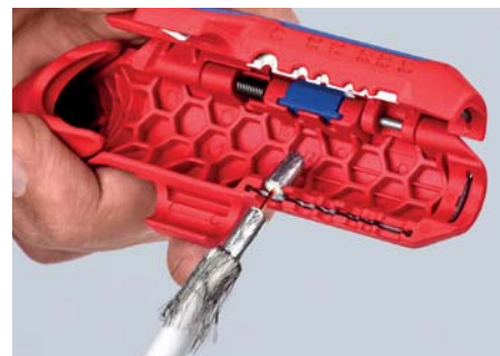
Usuwanie izolacji z kabli koncentrycznych
