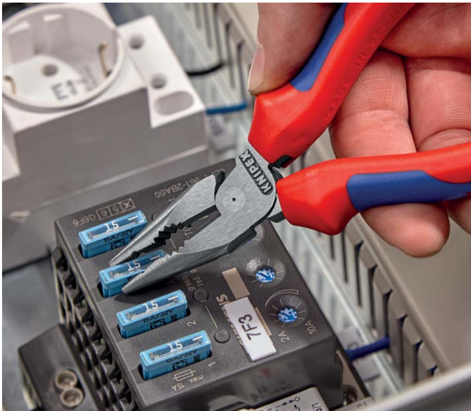
Powierzchnie chwytające ze specjalnie hartowanymi zębami: zawsze niezawodne; Chwytanie dzięki dużej odporności na zużycie
