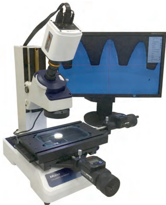
TM-505B wyposażony w opcjonalne głowice mikrometryczne Digimatic
