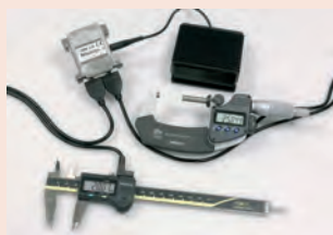
Przykład zastosowania z przełącznikiem nożnym (wyposażenie opcjonalne)
