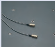
System kompensacji temperatury (czujniki temperatury)
