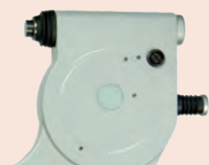
Śruba do regulacji mikrometru ± 5 μm
