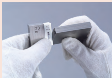
Płytki CERA - Niemagnetyczność
