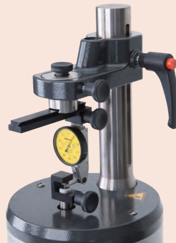
Wzorcowanie czujnika dźwigniowo-zębatego z dodatkowym wyposażeniem
