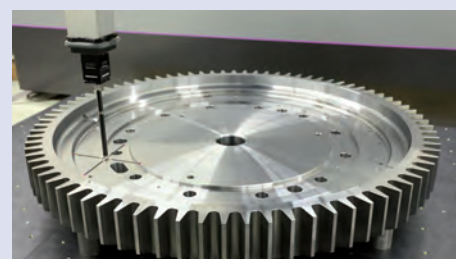
Skanowanie sondą SP80 z końcówką 100 mm.
