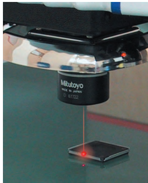
System automatycznego ogniskowania ze śledzeniem współosiową wiązką lasera (TAF)
