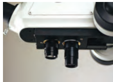
Zastosowanie opcjonalnego przesuwego modułu zmiany obiektywów, 2 obiektywy (opcja fabryczna)
