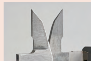
Powierzchnie pomiarowe szczęk z węgla spiekanego
