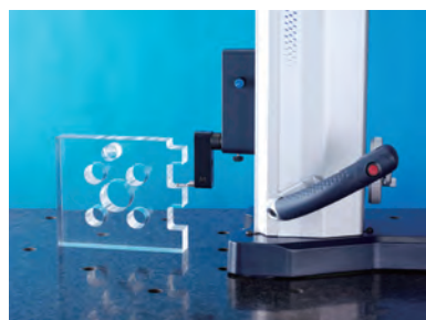
Przykład wykorzystania QM-Height z poduszką powietrzną
