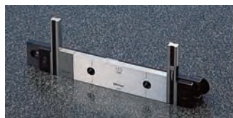
Uchwyt B i C : Służą do połączenia dwóch długich płytek wzorcowych z innymi płytkami wzorcowymi o długości do 35 mm (Uchwyt B) lub 140 mm (Uchwyt C). Wykorzystywane również do mocowania szczęk za pomocą dwóch adapterów. Uchwyt B : 619032 (R maks.= 90 mm- L= 126 mm) Uchwyt C : 619033 (R maks.= 200 mm- L= 236 mm)
