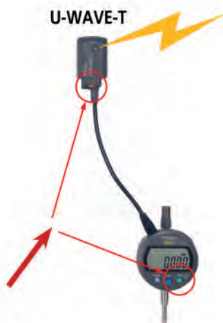
Kabel bez możliwości podłączenia przełącznika nożnego
