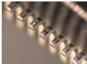
Przykład pomiaru : Wysokość wyprowadzeń obudowy QFP
