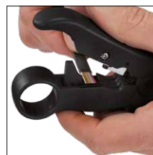
Abisolieren von Flachbandkabel Stripping of flat cables
