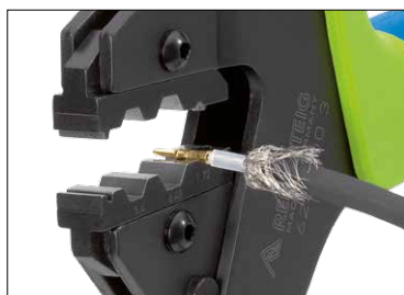
Zagniatanie przewodu wewnętrznego Inner conductor crimp
