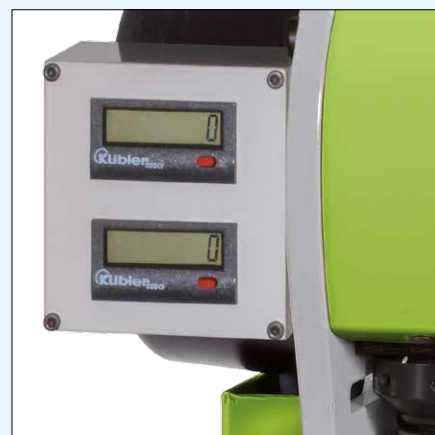
Licznik wykonanych połączeń
