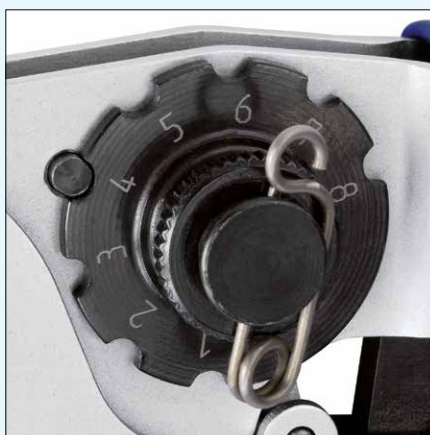
Ustawienie trzpieni zagniatających w zakresie 1-8 zgodnie z normą MIL/SAE AS22520
