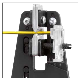
Kabel dosunąć do ogranicznika długości usuwanej izolacji Position cable at length stop
