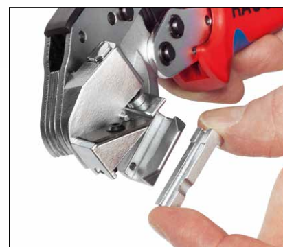
Łatwa wymiana prowadnika Easily interchangeable tube guide
