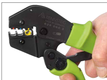
Mocowanie złącza przy użyciu niewielkiej siły Locate the contact with low force
