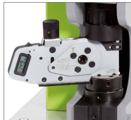
Zagniatarka pneumatyczna CM 25-3 CM 25-3 Pneumatic Crimping Machine
