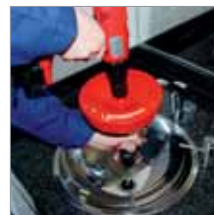
Wykonanie E napęd elektryczny przy pomocy wiertarki akumulatorowej
