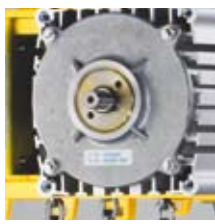
Zewnętrzne ustawianie sprzęgła przeciążeniowego
